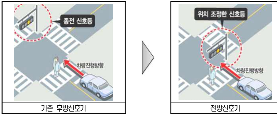
기존 후방신호기 및 전방신호기 설치 예시도
